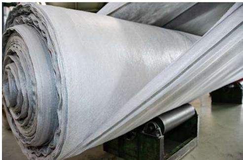
Bild 2: Bei TenCate Geosynthetics Austria wird dieser hochreißfeste PP-Vliesstoff hergestellt. Die anfallenden Randbeschnitte und Produktionsausschüsse werden auf einer ISEC evo Recyclinganlage zu Rezyklat wiederaufbereitet.
